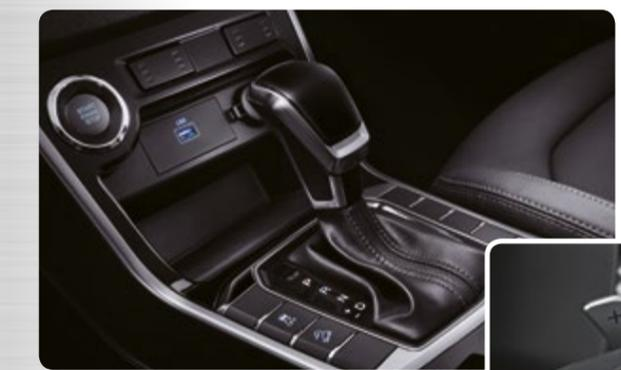
La transmisión automática AISIN de 6 velocidades te ofrece un cambio de marcha suave con la máxima eficiencia de combustible. Si prefieres una conducción más deportiva, controla el vehículo a través de las levas.
