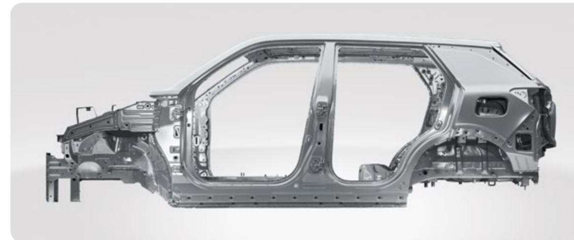
La estructura del nuevo Korando está fabricada con un 74% de acero de alta resistencia para asegurar una rigidez y seguridad perfectas. Este material se complementa con tecnología NVH de reducción de ruidos que garantiza un nivel de 44 dB.
