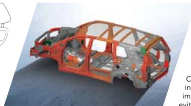
Carrocería monocasco con estructura integrada de dos piezas que dispersa los impactos frontales o descompensados y evita la invasión del motor en la cabina.
