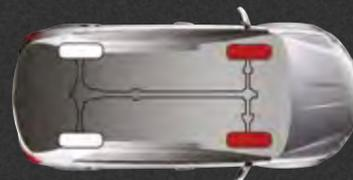
Tracción 2WD: Condiciones normales de carretera (tracción delantera).
