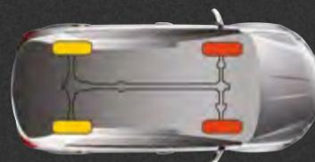
Tracción 4WD: En caso de necesitar mayor tracción, como en carreteras sin asfaltar o con nieve, el sistema entrega par al eje trasero (tracción total).
