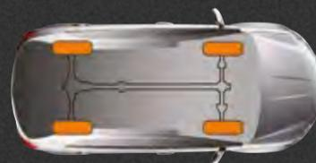
Modo 4WD LOCK: Utilízalo cuando necesites máxima adherencia al terreno (bloqueo del diferencial central).
