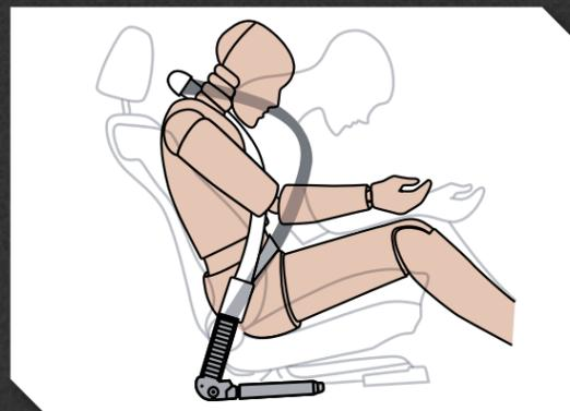
Cinturones de seguridad con doble pretensor y limitador de esfuerzo.
