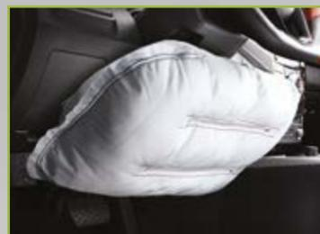
Airbag de rodilla del conductor.
