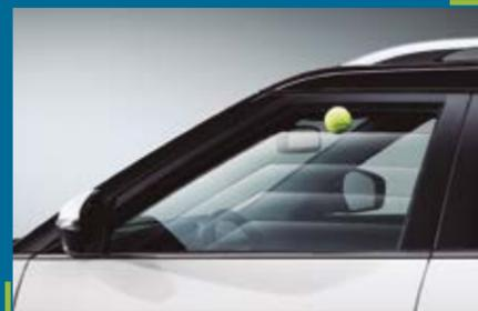
Elevallunas eléctricos (conductor de un sólo toque).
