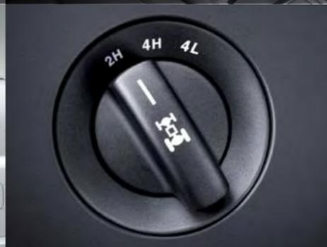
Tracción integral conectable con reductora
