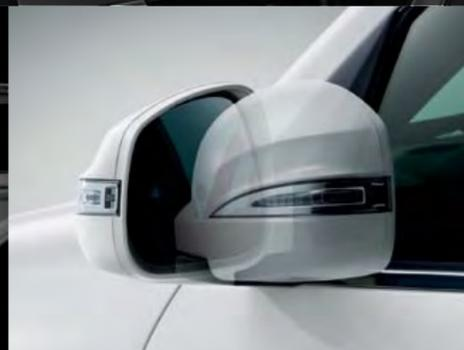
Retrovisores exteriores plegables electrónicamente
