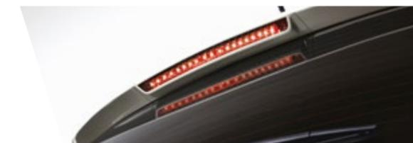
Spoiler con luz de freno LED integrada
