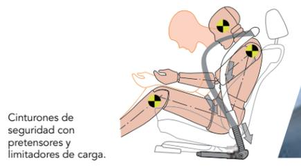
Cinturones de seguridad con pretensores y limitadores de carga.
