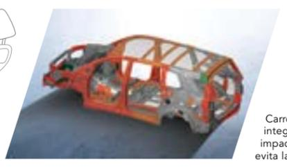
Carrocería monocasco con estructura integrada de dos piezas que dispersa los impactos frontales o descompensados y evita la invasión del motor en la cabina.
