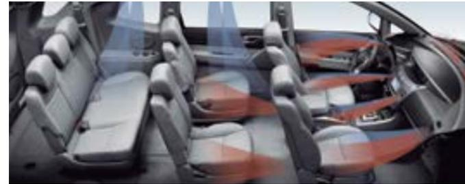
El climatizador automático optimiza el caudal del aire en todas las filas gracias al diseño específico de las salidas de aire
