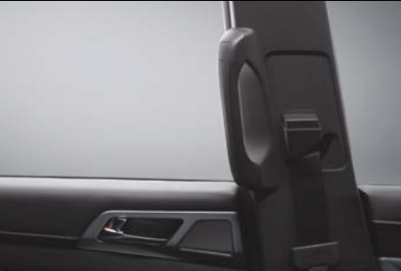
Asideros en el interior del pilar B
