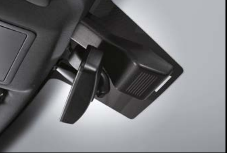
Módulo de cámara frontal con sensor de lluvia y luz
